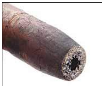
Bocal totalmente entupido (sem proteção E-Weld Nozzle)
